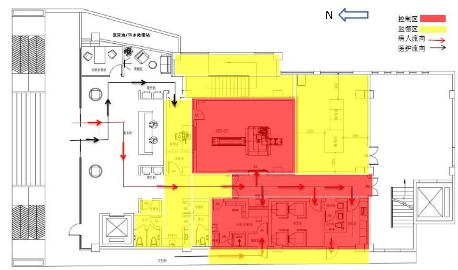
图3-1 影像中心1层平面图示意图
