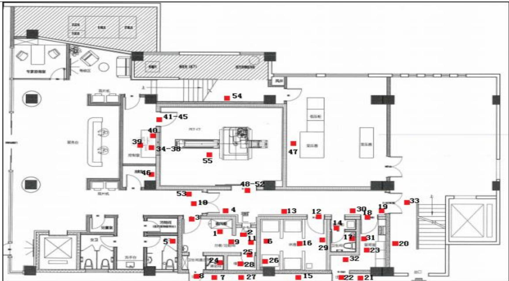
图 6-1 影像中心一层核医学科周围 X- $\gamma$ 辐射剂量率检测布点图
