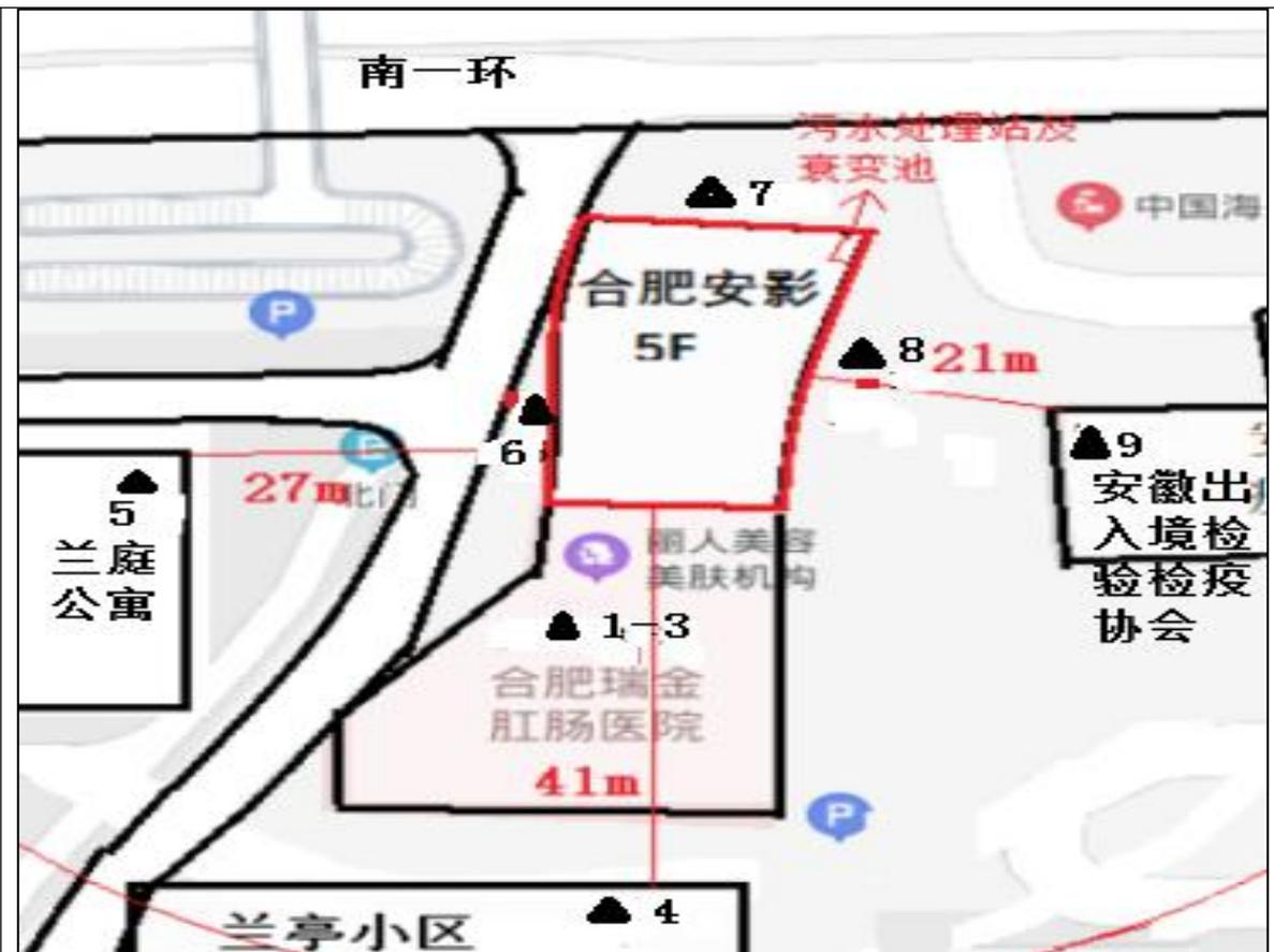
图 6-3 影像中心一层核医学科周围等效连续 A 声级 (dB (A)) 检测布点图
